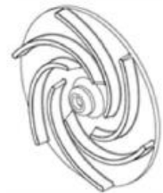
Impulsor Centrifugo abierto en Noryl
